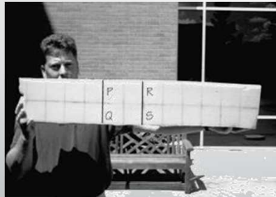
Viga previo a la flexión
